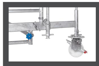
Der teleskopierbare Fahrbalken bildet die sichere Gerüstgrundlage bei größeren Aufbauhöhen und im Freien. Mit der stufenlos einstellbaren Stützspindel bleibt das Fahrgerüst waagerecht, auch wenn der verstellbare Fahrbalken ausgezogen wird. Zum Feststellen des Teleskoparmes wird bei den RapidTech Fahrgerüsten kein Werkzeug wie ein Hammer oder ähnliches benötigt.
