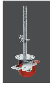
Die 11,9 kN Fahrrolle, Ø 200 mm, kann in allen RapidTech Aluminium Fahrgerüsten, unabhängig von der Aufbauhöhe, verwendet werden. Der der Spindelmutter Außenring angebrachte erleichtert das Auf- und Abspindeln wesentlich und verhindert Verletzungen an Kanten.
