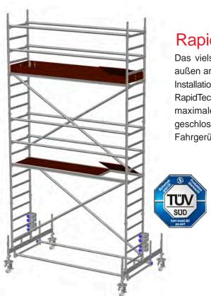
Das vielseitige Fahrgerüst für jeden Einsatzzweck. Ob Sie innen oder außen arbeiten, ob an Decken oder Fassaden, in Hallen oder Hangars, im Installationsbereich oder in der Instandhaltung – das Aluminium Fahrgerüst RapidTech 4601 mit einer Arbeitsfläche von 0,75 m x 2,85 m und einer maximalen Arbeitshöhe von 9,45 m im Freien und 13,45 m in geschlossenen Räumen erfüllt alle Anforderungen, die an ein Profi-
