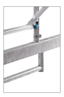
Der Rapidverschluss aus Alu-Kokillen bzw. Alu-Druckguss – bei Belägen, Riegeln und Diagonalen. Mit federunterstütztem Schließbügel aus schlagfestem Polyamid mit Stahleinlage. Die farblichen Bügel ermöglichen die einfache Unterscheidung zwischen Längsriegeln und Diagonalen – ohne zu messen. Die als Innenaufstieg dienenden Sprossen der Vertikalrahmen sind rutschsicher profiliert.
